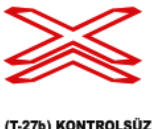
(T-27b) KONTROLSÜZ DEMİRYOLU GEÇİDİ (EN AZ İKİ HAT)
