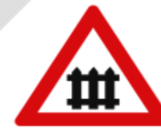
(T-25) KONTROLLÜ DEMİRYOLU GEÇİDİ
