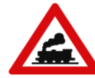
(T-26) KONTROLSÜZ DEMİRYOLU GEÇİDİ
